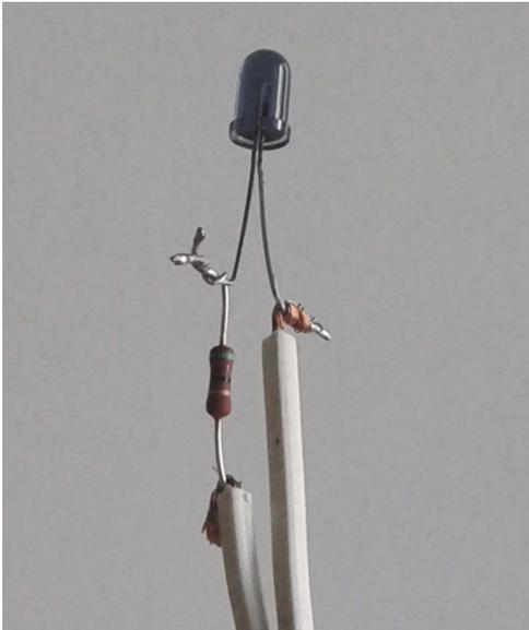
**Abb. C.2:** Die IR-Leuchtdiode wird durch Verdrillen mit einem Kabel und einem 50-Ohm-Widerstand verbunden.
