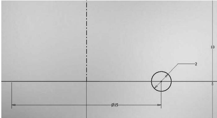
Abb. 1.19: Skizze mit Achse und Kreis-Profil für Spirale
