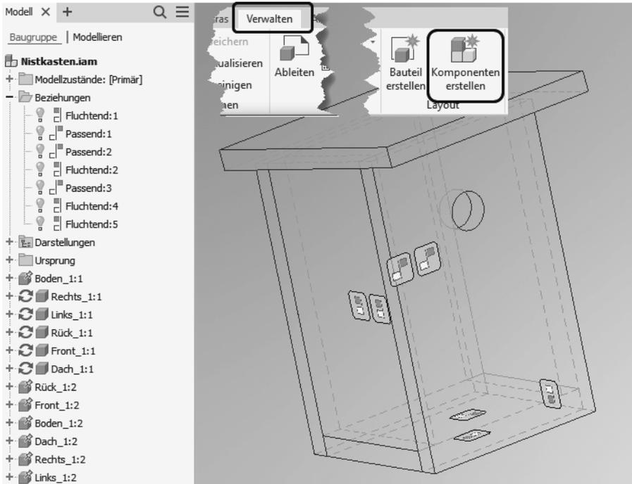
Abb. 1.47: Top-Down-Baugruppe mit Unterkomponenten und automatisch erzeugten Abhängigkeiten
