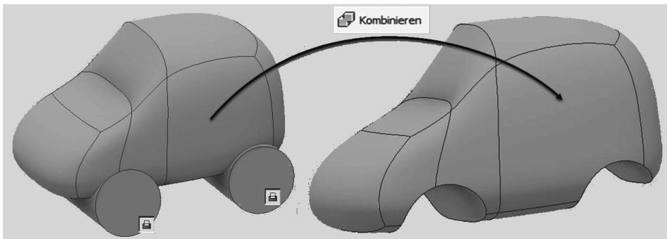
Abb. 1.31: Modifizierte Freiformgeometrie kombiniert mit Zylindern durch Differenzbildung
