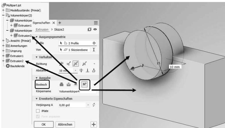
Abb. 1.23: Multipart-Teil mit zweitem Volumenkörper als eigenständiges Teil
