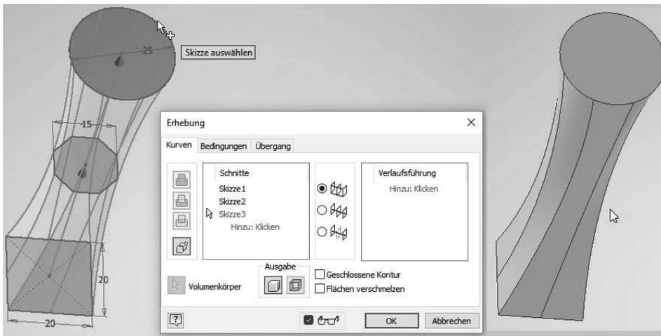
Abb. 1.18: Drei Profilskizzen zur Erstellung eines Lofting-Körpers
