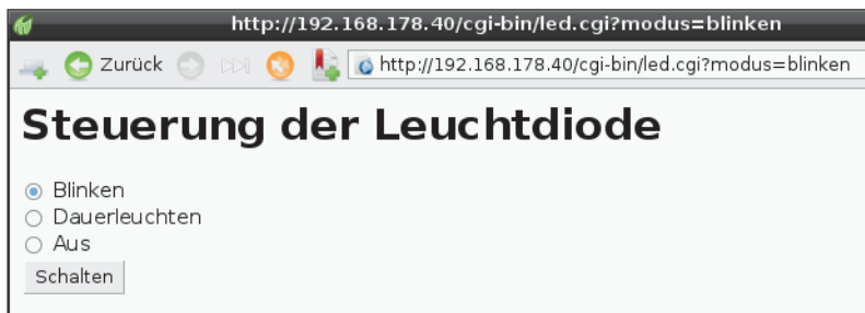
Abb. Y.9: Interaktive Webseite zum Steuern einer Leuchtdiode mit Radiobuttons
